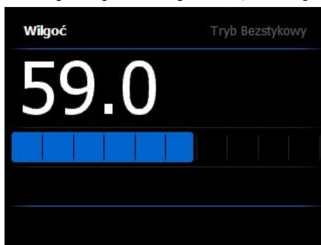
Fotografia 9. Pomiar wilgotności ściany wewnętrznej korytarza. Najwyższy ze stwierdzonych pomiarów. Wskazanie urządzenia 59,0, w skali 1-100 - ściana wilgotna.
